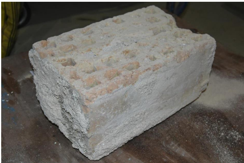
Slika 4.34: Vzorec votlega opečnega zidak, odvzet iz zidu iz l. 1969 na mestu Z4.
