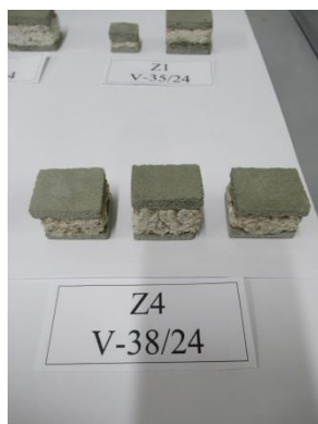
Slika 4: Vzorec malte Z4 (fotoarhiv 047868d-07)
