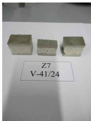
Slika 7: Vzorec malte Z7 (fotoarhiv 047868d-10)
