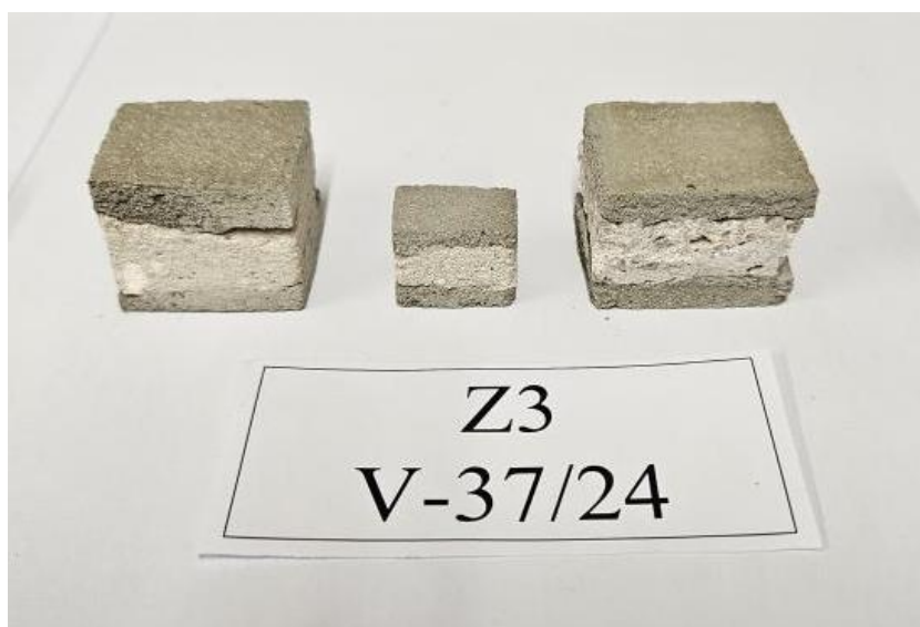
Slika 4.42: Vzorci, izdelani iz kosov malte s preglednega mesta Z3 in pripravljeni za tlačni preskus.
